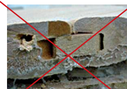
Keine Leisten zwischen den Dielen einsetzen!
